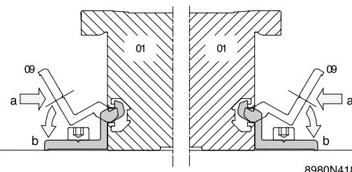
6. Enclipsier 2 pattes de serrage (09) sur le profilé du capteur (a) au niveau de l'arête extérieure gauche du capteur (01) et rabatter sur le profilé de base (b). Visser les deux pattes de serrage avec les vis à tête cylindrique M8x14 dans les cales coulisseau.
