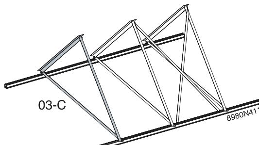
7. Insérer un écrou à encastrer (23) dans le profilé de base (04) et le bloquer en le tournant de 90° (↗). Placer une douille d'écartement (22) sur l'écrou à encastrer et fixer le montant de la traverse croix (24) à l'aide d'une rondelle-ressort (21) et d'une vis autoperforante (15). Serrer la vis autoperforante jusqu'à entendre un net craquement. Continuer de visser et serrer normalement.
