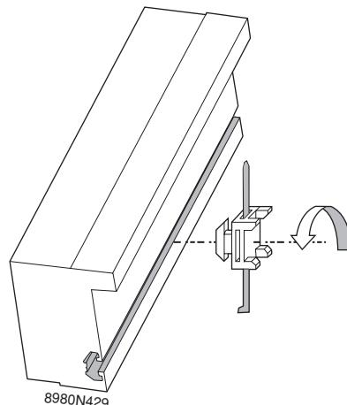
4. Insérer les blocs de raccord de câbles dans la rainure multifonctions au niveau du profilé du capteur et les faire pivoter de 90°. Amener un attache-câbles (court) à travers le bloc de fixation, le poser autour du câble et le fixer. Couper les bouts qui dépassent.
