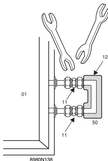
1. Retirer les couvercles de protection en plastique des raccords et fixer les raccords à bague de serrage (11) sur les raccords des capteurs.
