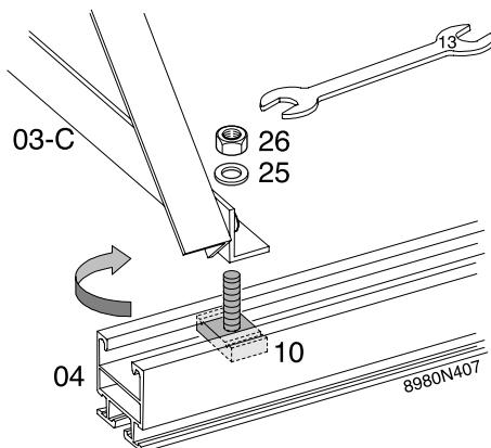
3. Fixer l'équerre de montage sur le profilé de base à l'aide des vis à encastrer (10), des rondelles en éventail (25) et des écrous (26) fournis.
