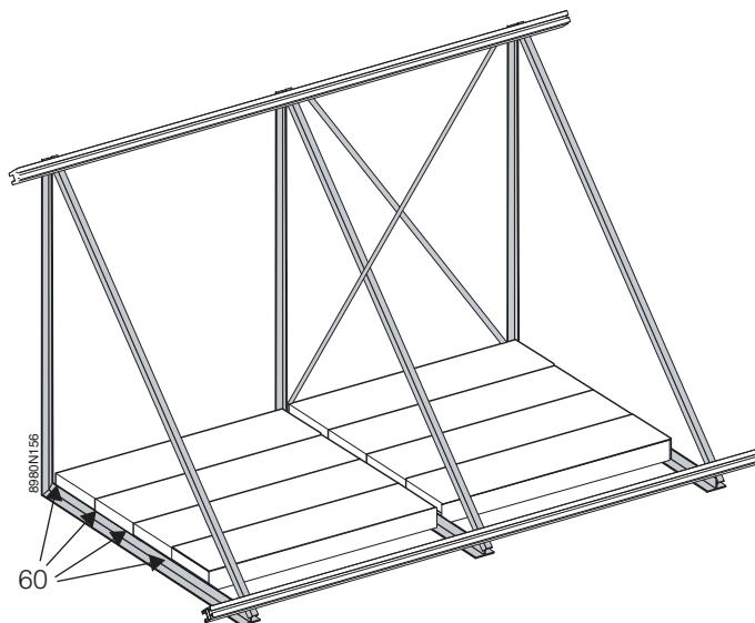
11. Basculer le support de montage de façon à orienter les profilés en T vers le bas, orienter le support selon le plan établi et le stabiliser par vissage ou lestage.
