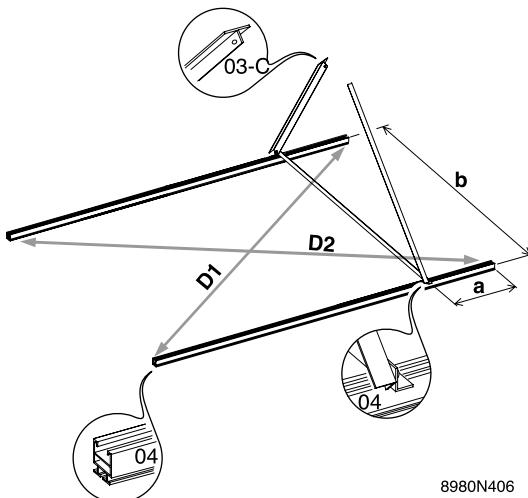
1. Poser les profils de base (04) sur la zone de montage, la rainure large orientée vers le haut.
