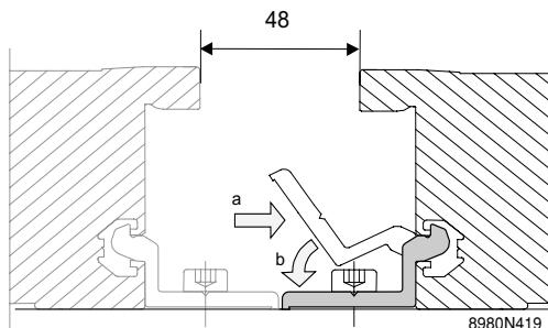
12. Placer la patte de serrage sur le profilé du capteur et rapprocher les deux capteurs.
