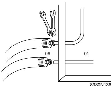
Repousser l'isolation thermique du kit de raccordement des capteurs, fixer les raccords à bague de serrage sur les raccords de liaison et visser.
